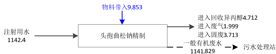
图 3.4.1-5 头孢曲松钠精制水平衡图 (m³/a)
