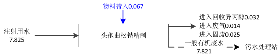
图 3.4.1-4 头孢曲松钠精制水平衡图 (m³/d)
